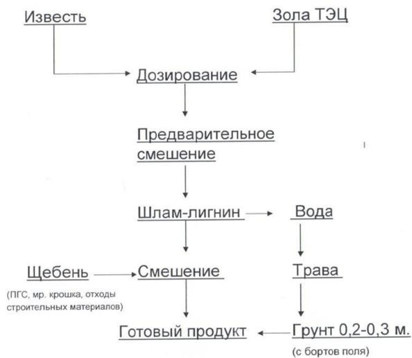
Рис. 1. Технологическая схема обезвреживания и рекультивации шлам-лигнина
