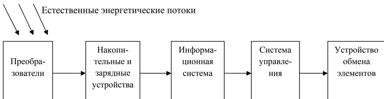
**Структура электрической зарядной станции**
